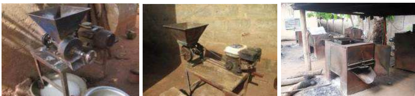
Photo 7 : Broyeur de soja électrique (à gauche), à carburant (au milieu) et torrificateur artisanal
